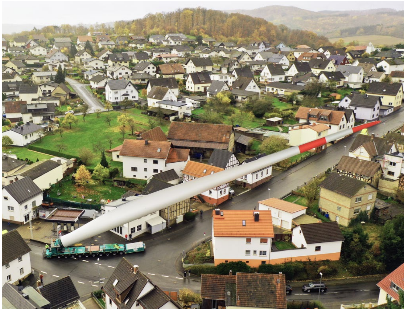
Der Transport von WEA-Bauteilen wie Rotorblättern ist oft schwierig, wie die Aufnahme aus Hessen zeigt.
